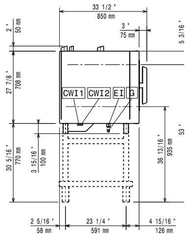
CWI1 = Kaltwasserzulauf                      EI = Elektroanschluss
